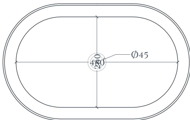
N.B. Le misure indicate possono subire una variazione dell'0,6% circa, dovuta ad usura stampi e a variazioni delle caratteristiche tecniche relative alle materie prime che compongono l'impasto.
